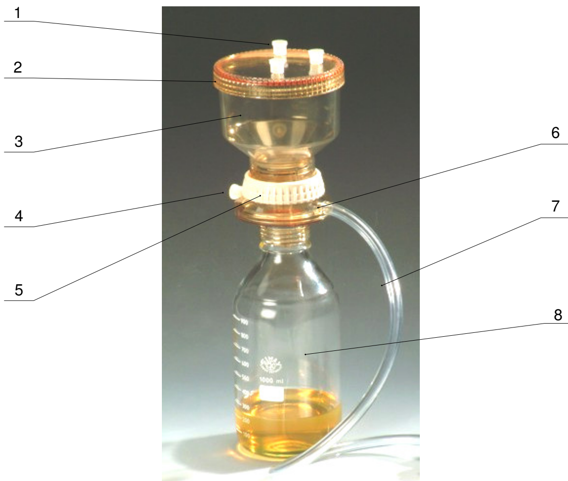
Wyszczególnienie elementów składowych zestawu do sączenia cieczy
