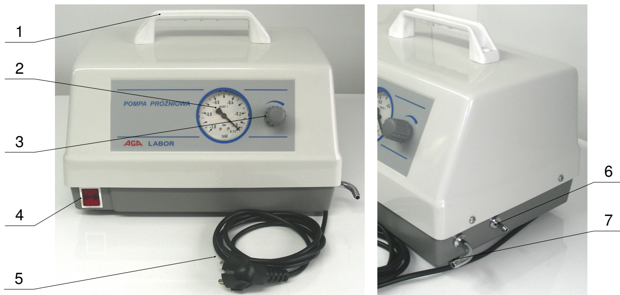
Wyszczególnienie elementów składowych pompy elektrycznej
